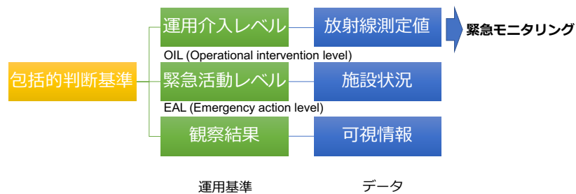
図 09-1 包括的判断基準と運用基準の関係 (IAEA Safety Standards GSG-2, Fig.1)
