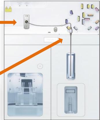
フローセル：ディスポ サンプルラインも簡単に交換
